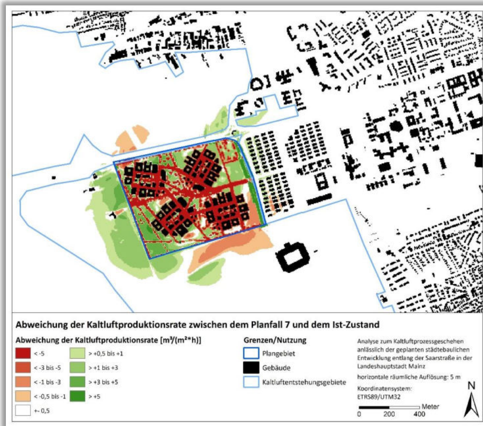
Abb. 23: Abweichung der Kaltluftproduktionsrate zwischen dem Planfall 7 und dem Ist-Zustand.
