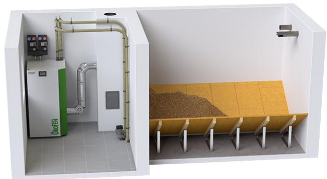
Abbildung 2: Bsp: Seitenansicht von links nach rechts: Pellet-Kessel, Kamin, Pellet-Lagerraum mit Schrägboden
